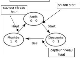
0 0 , 01 , 1 0 : correspond à la commande de 2 relais 0 0 moteur à l'arret 01 moteur sens descente 10 moteur sens montée
